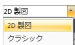
画面左上の【ワークスペース】から【2D 製図】を選択するとリボンが表示されます。【クラシック】を選択するとメニューバーとツールバーが表示され、リボンは表示されなくなります。
