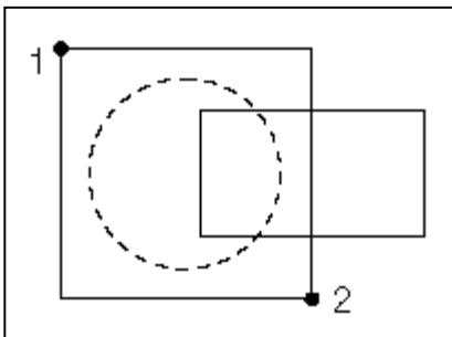
実線の窓枠に完全に囲まれたオブジェクトだけを選択します。
