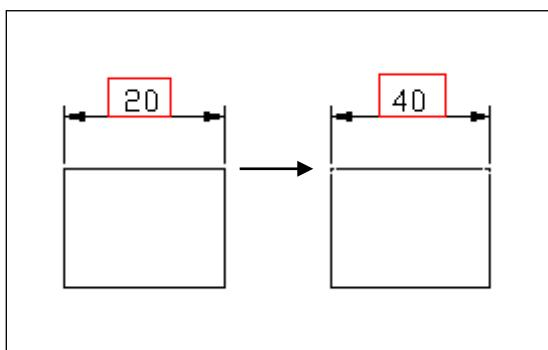
寸法値の編集は、図面上の寸法図形をダブルクリックし、表示されるプロパティウィンドウから内容を変更することができます。
