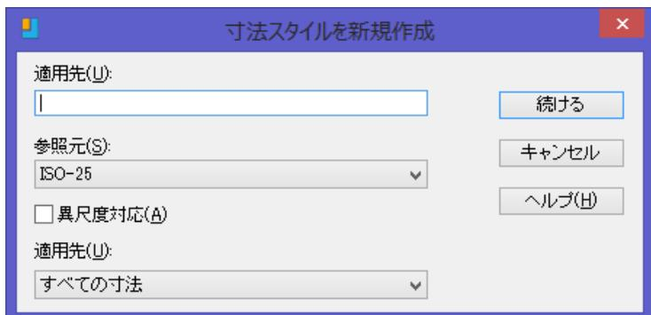
②「寸法スタイルを新規作成」ダイアログボックスが表示されますので、スタイル名を入力します。
